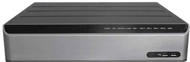
Сетевые видеорегистраторы STNR-A0830/A1630 серии Neyro II с поддержкой компрессии H.265 представляют собой системное высокопроизводительное решение для записи и отображения видео с разрешением до 4K в реальном времени с функцией обработки метаданных видеоаналитики на основе нейросетей.
