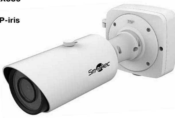
IP-камера STC-IPM5614A Estima выполнена в металлическом корпусе, имеющем класс климатической защиты IP67 и оснащена моторизованным объективом с автодиафрагмой. Шарнирное крепление камеры позволяет выполнить установку как на горизонтальные, так и на вертикальные поверхности. В комплекте с камерой поставляется монтажная коробка.
