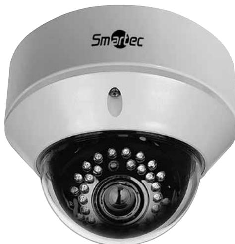
IP-камера STC-IPM12550A использует 1/1.7" 12-мегапиксельную КМОП-матрицу Sony Starvis™ IMX226, обеспечивающую особо высокое разрешение и чувствительность и позволяющую формировать видеоизображение с минимальным уровнем шумов.
