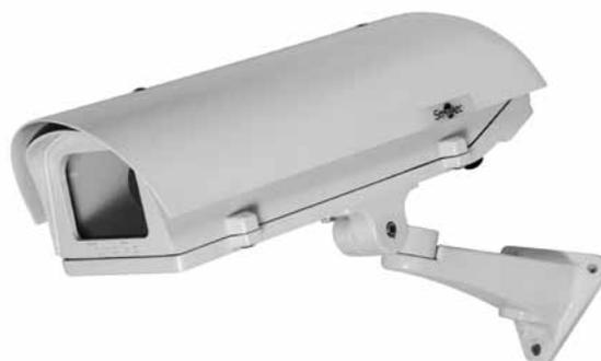
Термокожух STH-3230D-PSU1 – это оптимальный выбор для защиты телекамеры от климатических воздействий в широком диапазоне температур. Интегрированный солнцезащитный козырек предотвращает попадание прямых солнечных лучей на стекло и появление бликов. За счет конструкции козырька создается воздушный зазор, который дополнительно предохраняет телекамеру от перегрева при высоких положительных температурах, поэтому кожухи этой серии можно особо рекомендовать для IP-камер.
