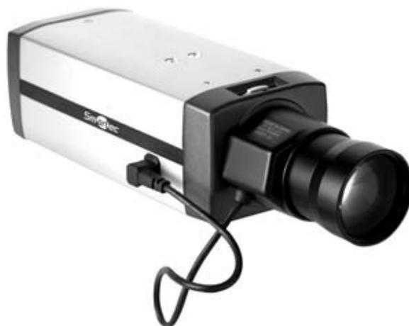
Универсальная IP-камера STC-IPM3091A использует 1/2.5" мегапиксельный КМОП-сенсор с прогрессивной разверткой, с помощью которого формирует видеоизображение с разрешением до 1280x720 пикселей. Для совместного использования с камерой рекомендуются мегапиксельные объективы, как с ручной регулировкой диафрагмы, так и с автоматической. Наличие программного режима «день/ночь» позволяет применять STC-IPM3091A в условиях пониженной освещенности.
