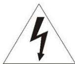
Символ вспышки молнии с острым наконечником в равностороннем треугольнике предупреждает пользователя, что внутри корпуса находятся неизолированные от “опасного для жизни напряжения” участки, где проходящий ток опасен для жизни.
