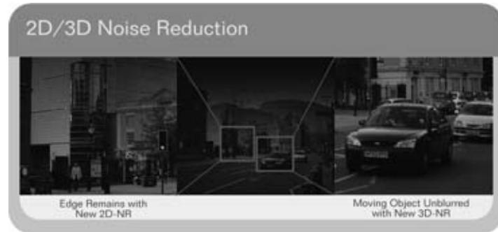
Система динамического 2D/3D шумоподавления Effio, как следует из названия, эффективно отрабатывает помехи и «смазы», как на статичных, так и на движущихся объектах. Последнее важно для корректного отображения динамичных сцен при недостаточном освещении, когда режим накопления кадров обычной камеры неэффективен.
