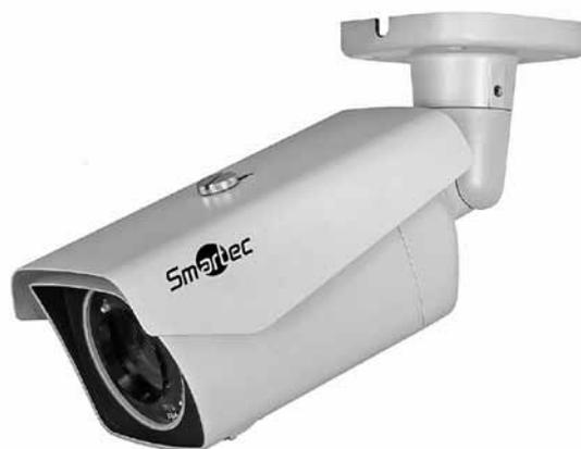
За счет применения высокочувствительной матрицы Sony IMX178 с увеличенными размерами (1/1.8'') достигается трехкратное увеличение чувствительности по отношению к стандартным 2-3-мегапиксельным IP-камерам, построенным на матрицах формата 1/2.8''. Это дает возможность получения информативного цветного изображения при низкой освещенности – в ситуациях, когда стандартные IP-камеры уже вынуждены перейти в черно-белый режим.
