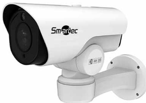
Компактная поворотная IP-камера STC-IPM5911 Estima является эффективным решением для большинства задач видеонаблюдения в уличных условиях. Это обеспечивается благодаря наличию функционального модуля камеры с высокочувствительной 5 Мп КМОП-матрицей Sony, широким динамическим диапазоном, быстрым автофокусом, развитым детектором движения, адаптивной комбинированной подсветкой и другим функциям.
