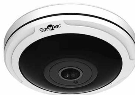
IP-камера STC-IPM12140A Estima использует 1/1.7" 12-мегапиксельную КМОП-матрицу Sony IMX226, обеспечивающую особо высокое разрешение и чувствительность и позволяющую формировать видеоизображение с минимальным уровнем шумов. Камера предназначена для установки на горизонтальную или вертикальную поверхность. При этом, за счет использования широкоугольного объектива «рыбий глаз» с углом обзора, приближающимся к 180°, она способна обеспечить полный обзор наблюдаемой площади без «мертвых зон».
