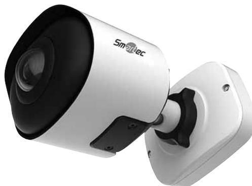
Панорамная IP-камера STC-IPM8110A Estima выполнена в металлическом вandalозащищенном корпусе с интегрированной коммутационной коробкой. Камера оснащена ультракороткофокусным фиксированным объективом типа «рыбий глаз», что обеспечивает панорамный обзор по горизонтали с углом зрения 180°. Шарнирное крепление камеры позволяет выполнить установку как на горизонтальные, так и на вертикальные поверхности. Камера имеет рейтинг антивandalной и погодной защиты (IK10, IP67).
