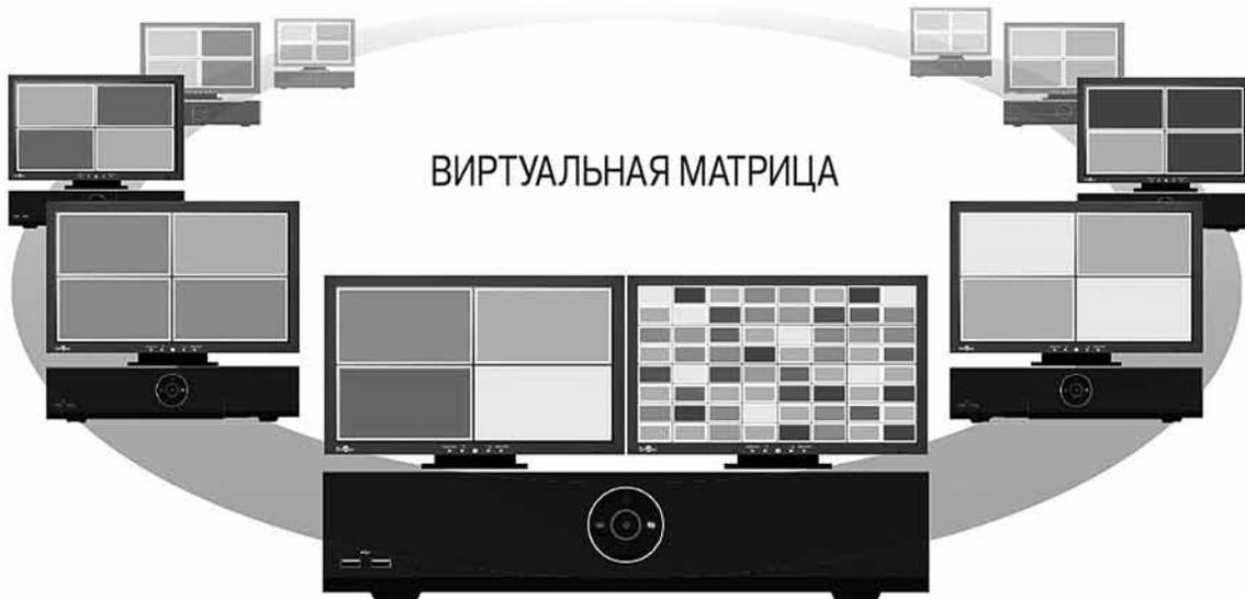
Технологии WARP и виртуальной матрицы, появившиеся в новой Delta-серии сетевых и гибридных видеорегистраторов Smartec, поднимают на новый уровень степень интеграции между устройствами. То, что раньше было возможно только с применением мощных и дорогостоящих рабочих станций и специализированного ПО, теперь реализовано в самих видеорегистраторах. Это не только упрощает работу с такими системами и повышает их надежность, но и дает значительный экономический эффект.
