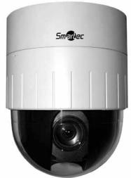
блюдаются резкие перепады освещенности (например, если телекамера, находящаяся в затемненной комнате, направлена на окно) или при встречной засветке телекамеры фарами автомобиля. Это достигнуто благодаря использованию процессора цифровой обработки сигнала Effio-S.
