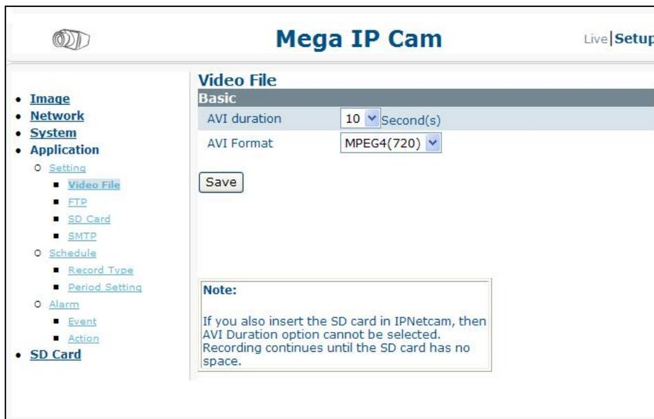
Этот раздел позволяет выполнить настройку таких установок, как «Настройка» (Видеофайл (Video File), FTP, SD-карта (SD Card) и SMTP), «График» (Schedule) (Тип записи (Record Type) и Настройка времени (Period Setting)) и «Тревога» (Alarm) (Событие (Event) и Действие (Action)).
