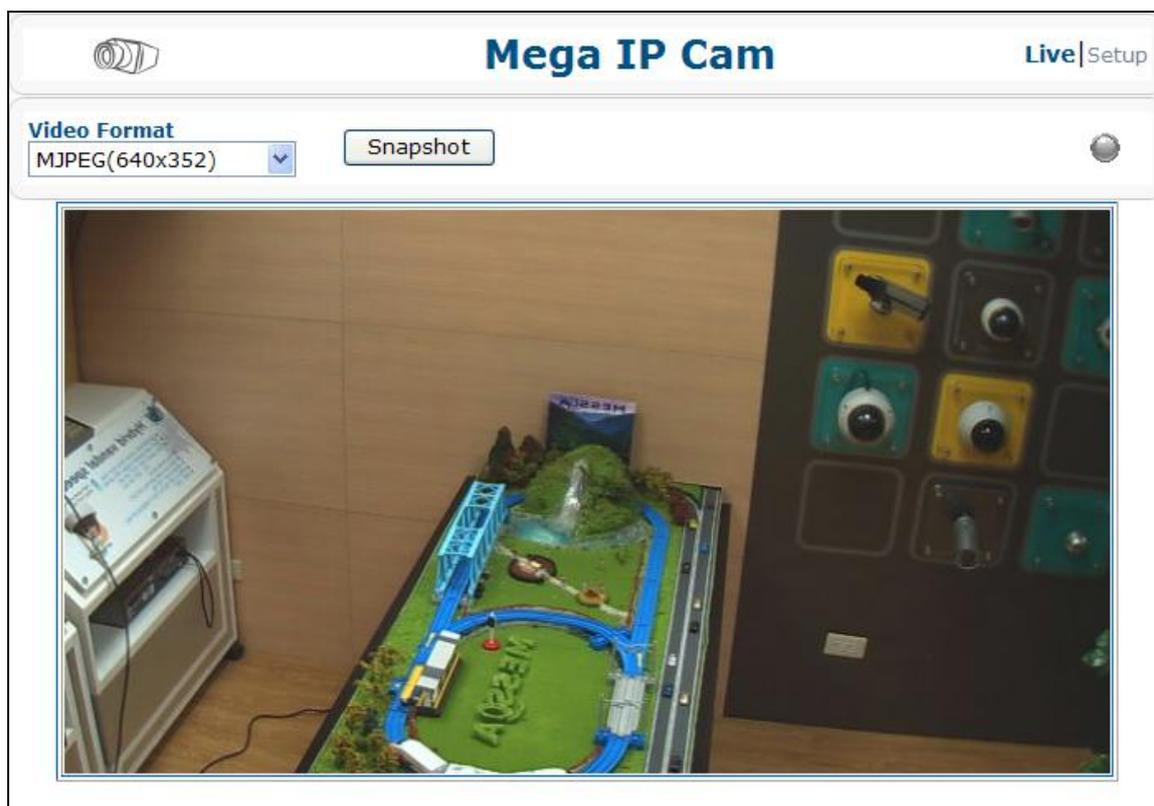
Экран просмотра живой картинки предназначен для работы с телекамерой обычных пользователей. В режиме просмотра живой картинки предлагаются функции «Видеоформат» (Video Format), «Моментальный снимок» (Snapshot), «LED записи» (Recording LED), «Живая картинка» (Live) и «Настройка» (Setup). Обратите внимание, что только администраторы могут пользоваться функцией «Настройка» (Setup) для изменения установок телекамеры.
