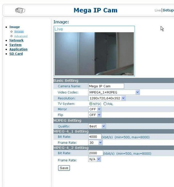
Для настройки установок телекамеры нажмите «Настройка» (Setup). Слева расположена навигационная панель, на которой имеется 5 категорий установок. Установки «Изображение» (Image), «Сеть» (Network), «Система» (System) и «Функции» (Application) предназначены для администраторов и позволяют выполнить настройку функций телекамеры.
